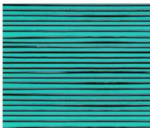
**31 fili di polietilene da 0,50 mm** di diametro protetti contro i raggi U.V. del sole, garantiscono una eccezionale resistenza meccanica.
