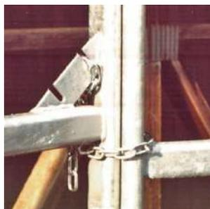
Il fissaggio tra un pannello e l'altro avviene con catena per adattarsi meglio al suolo; per applicazioni speciali usiamo invece un perno. Il sistema è studiato per essere trasportato anche in un trailer.
