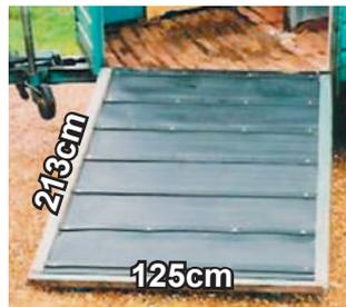
**Istruzioni:** Posate i tappeti con la parte seghettata rivolta verso l'alto della rampa. Pulite e sgrassate bene sia la rampa che il retro del tappeto. Effettuare eventuali tagli con un buon cutter. Fissare con collante specifico per gomma (mono-componente poliuretano). Per una massima prestazione di tenuta consigliamo l'uso della colla più le viti autofilettanti testa a martello, tenete conto di usare per ogni tappeto almeno 3 viti ogni traversino (la porzione di gomma più spessa).
